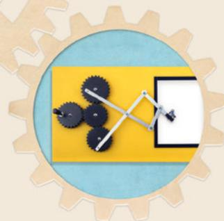
Mecanismo de engranajes que generan una forma geométrica. Este juego es la fusión entre el armonógrafo, aparato mecánico compuesto de dos péndulos que mueven al mismo tiempo un bolígrafo y una superficie plana, y el pantógrafo, aparato usado en cartografía para copiar imágenes.
